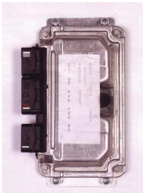
*Le calculateur est équipé d'un connecteur 112 voies.*
