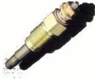
Le système de préchauffage a donc pour rôle de créer un point chaud dans la chambre de combustion, en face du jet de l'injecteur, afin de permettre la vaporisation, l'oxydation et la combustion des molécules de carburant.
