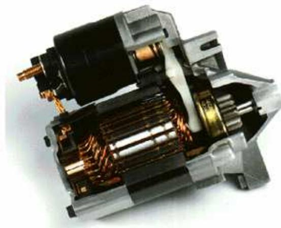
Effectivement les progrès réalisés dans le traitement des matériaux permettent de simplifier la construction de nombreux produits aujourd'hui. Les démarreurs n'échappent pas à la règle et on peut voir depuis quelques années des démarreurs d'une dizaine de centimètres de diamètre montés sur des moteurs six cylindres de trois litres de cylindrée, et ce pour des longueurs souvent inférieures à celles rencontrées jusque là.
