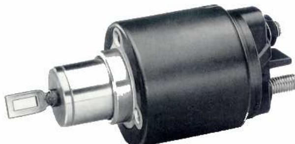
C'est aussi un électro-aimant qui a pour fonction d'engager le pignon de démarreur sur la roue dentée du volant moteur. Il comporte deux enroulements qui fonctionnent ensemble uniquement en phase d'appel. Seul celui de maintien sera actif pendant le démarrage.
