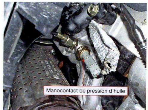
5) Indiquer quels seraient les contrôles à effectuer si les relevés de la pression d'huile ne coïncidaient pas avec ceux prévus par le constructeur
