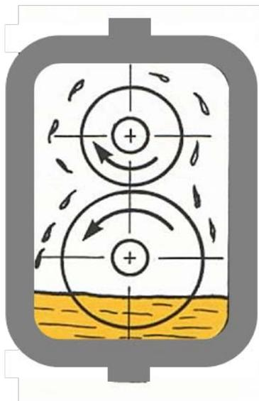
Une partie des pignons seulement est en contact du bain la d'huile et, l'huile prélevée en tournant assure le graissage de denture des pignons.
