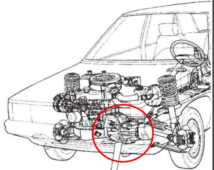
**Au démarrage, il assure un accouplement progressif entre moteur et organes de transmission.**
